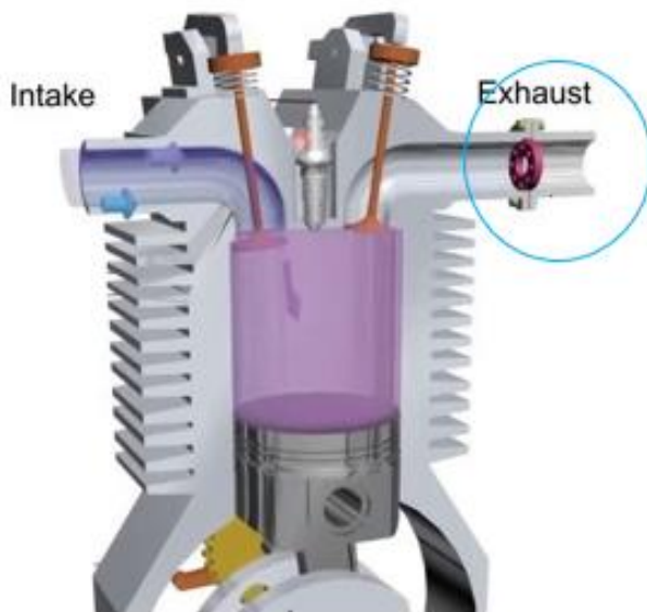
Gambar 4. Pemasangan orifice pada Exhaust manifold
